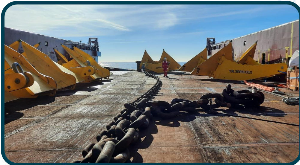
Ancre STEVSHARK et chaines d'ancrage (©EFGL, Maersk)
