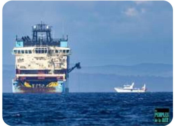
Les ancrs et chaînes ont d'abord été chargées à bord de ce navire grâce au personnel de la société Sea Invest. Les opérations se sont ensuite déroulées sur le site d'installation de la ferme éolienne, située à 16 kilomètres au large de Leucate et du Barcarès, avec l'assistance d'un navire de remorquage pour le tensionnement des ancrs. Les lignes d'ancrage garantiront une meilleure stabilité en mer aux flotteurs de la ferme éolienne.
